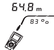
Figura 9.2 Determinación del valor NVP real del cable
