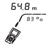
Figura 9.2 Determinazione del valore NVP effettivo del cavo
