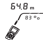
Abbildung 9.2 Bestimmung des tatsächlichen NVP-Werts des Kabels
