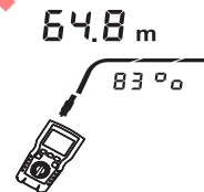
Rysunek 9.2 Określanie rzeczywistej wartości NVP kabla
